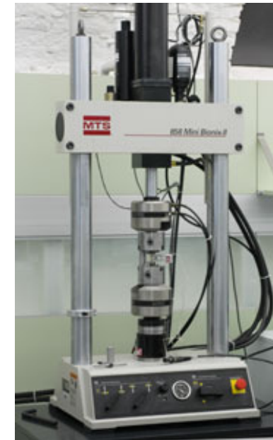
MTS 858 Mini Bionix 25KN Axial, 250 Nm Torsion
